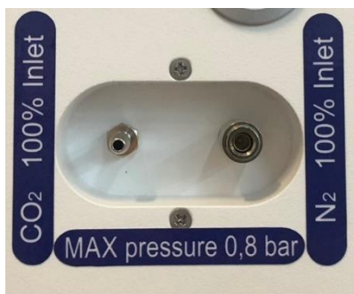
Figur 11.1 Gasinlopp på baksidan av MIRI® II-12 IVF-inkubator med flera kammare
