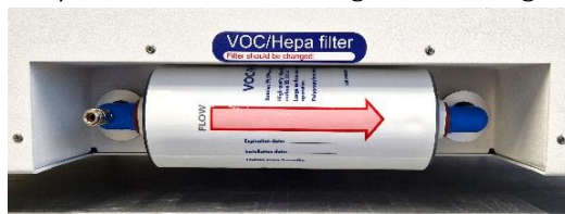
Figur 12.3 Korrekt installerat VOC/HEPA-filtret
